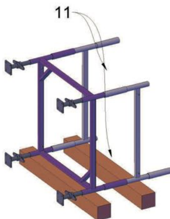
Figura 11 - inserimento telaio di base nelle basette regolabili
